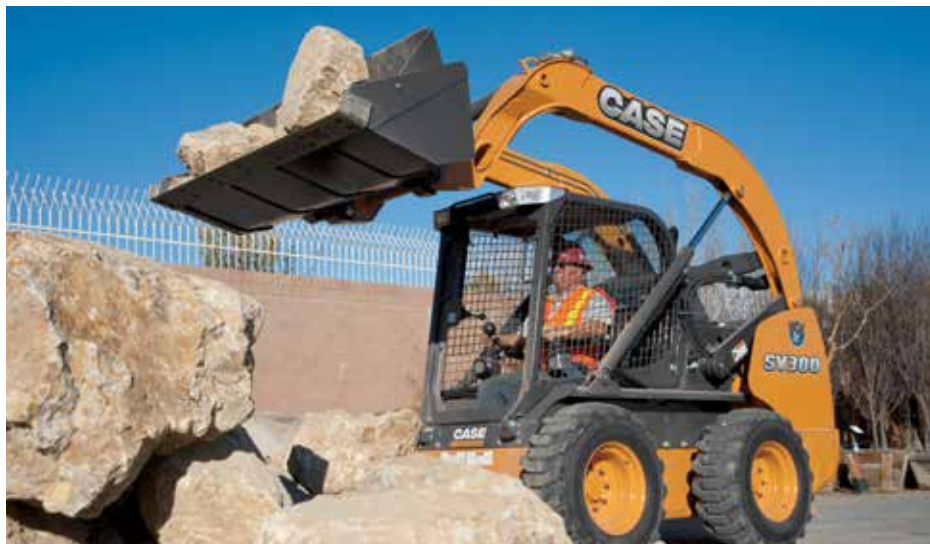
Com um acoplador rápido, você pode trocar implementos sem sair da cabine.
